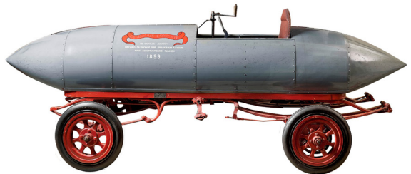
Figura 3.- Auto La Jamais Contente, construido en 1898, el primer auto en superar los 100km/h
